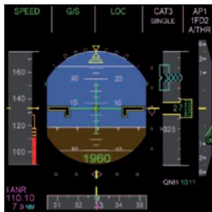
รูป 119 แผงหน้าปัดของเครื่องบินแสดงค่าระยะความสูงของอากาศยานเหนือพื้นดินที่วัดโดย RA
