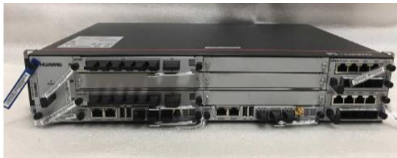
รูป 28 สถานีฐาน 5G ภายในอาคาร รุ่น 5G AAU5613 และ BBU5900 ของบริษัท Huawei
