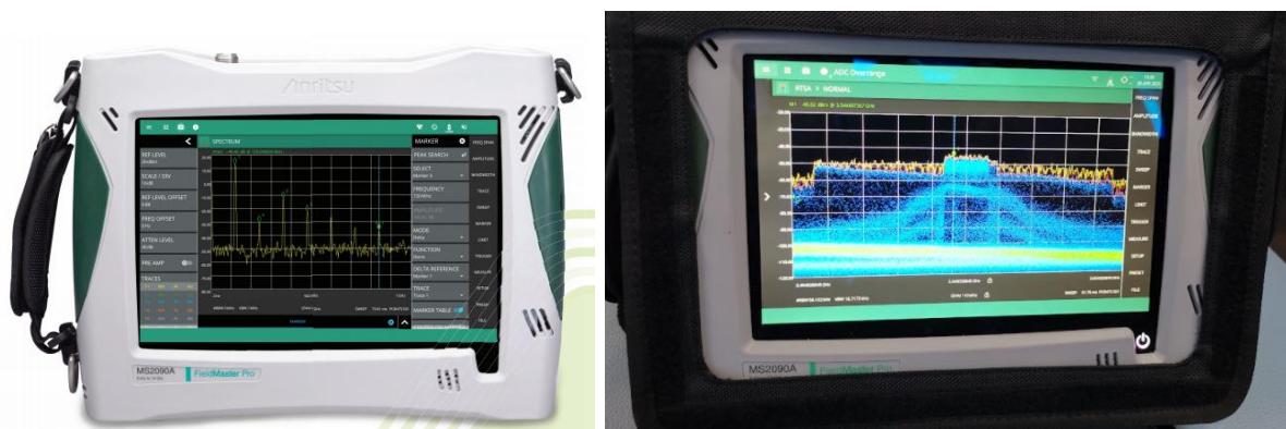
รูป 32 เครื่องวิเคราะห์สเปกตรัมสัญญาณ ตราอักษร Anritsu รุ่น Field Master Pro
