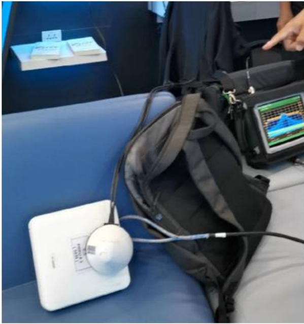
รูปการวางสายอากาศของเครื่องมือวัดใกล้กับสถานีฐาน 5G
